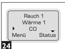
In diesem Beispiel werden 'Rauch' und 'Wärme' als simultane Prüfung ausgewählt (24).
