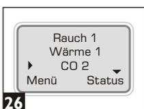
In diesem Beispiel werden 'Rauch' und 'Wärme' simultan und anschließend (seriell) wird 'CO' geprüft (26).
